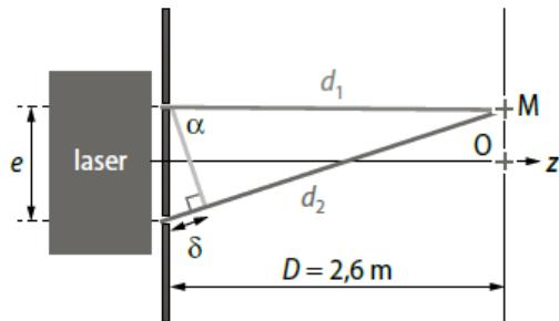
b. Le point O au centre de l'écran est sur une frange brillante, car il est tel que  $\delta = 0$ . En effet, les interférences sont constructives si  $\delta = k \cdot \lambda$ , et ici,  $k = 0$ .
